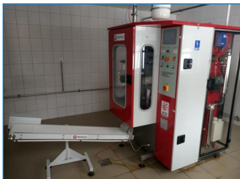
Fot. Wodociąg publiczny - Żagań ul. Dworcowa 59 – automatyczna paczkowarka wody typu PROFIFICO AQUAPACK 2, pomieszczenie hali filtrów do pakowania wody pitnej
